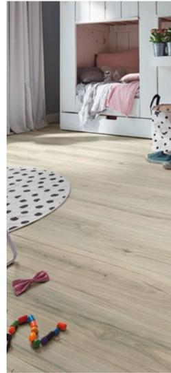
**MeisterDesign. laminate LD 150**, Kurzdiele, Beanspruchungsklasse 23/32, längsseitige V-Fuge und kopfseitige Microfuge, feuchtraumgeeignet, 4 Stunden wasserresistent, Diamond Pro-Oberfläche, antistatische Oberfläche, Klicksystem: Multiclic, MEISTER-Garantie\* 25 Jahre im Wohnbereich, 5 Jahre im gewerblichen Bereich, Stärke: 8 mm, Deckmaß: 1.288 x 198 mm
