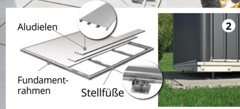
Gerätehaus Neo, Gr. 2B, in quarzgrau-metallic mit Doppeltür, Lichtpaneel, SmartBase Fundament und Innenwandverkleidung als Zubehör
